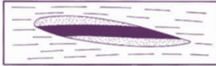
مصددة طبقية على هيئة تكوين رملي عكسي محاط بطفل صخري غير منفذ
